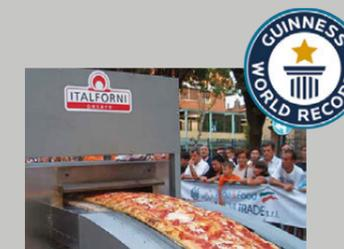
2009 — ● **BREVETTO TUNNEL.** Viene brevettato e introdotto sul forno Tunnel il nastro trasportatore in pietra refrattaria, grande innovazione in termini di qualità e prestazioni.
